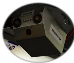
Figure 2.32 – Capteur IP audio/vidéo intelligent DéGIV
