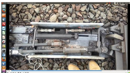
Figure 2.23 – Moteurs d'aiguille électro-hydraulique et Moteur de Passage à niveau PN68
