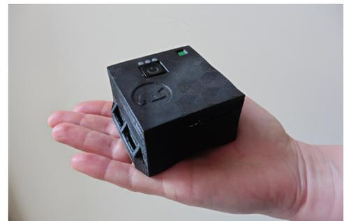
Figure 2.2 – Équipement GNSS et IMU développé sur mesure pour les recherches en navigation multimodale du voyageur avec batterie et mémoire intégrées.
