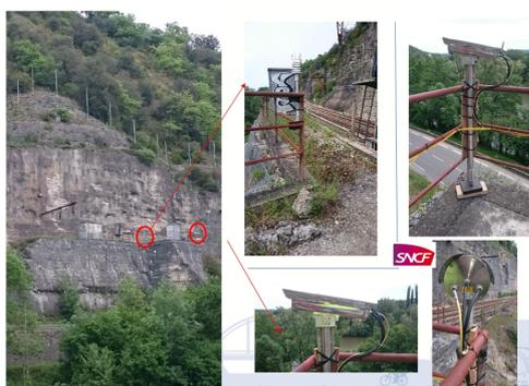
Figure 2.24 – Dispositif de monitoring IR en continu avec traitement
