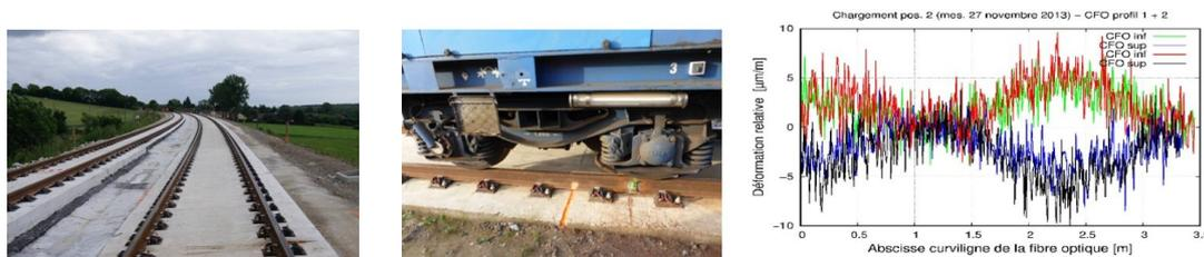
Figure 2.10 – Voie non ballastée, instrumentée à coeur par capteurs à fibres optiques et accéléromètres entre Gisors et Cerqueux. A droite les mesures de déformation au cours du temps.
