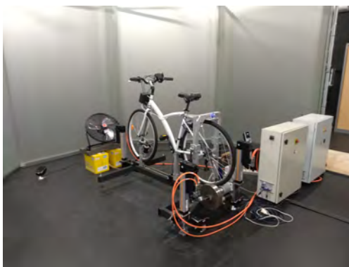
FIGURE 2 – Simulateur vélo équipé de vérins pour restituer les vibrations.
